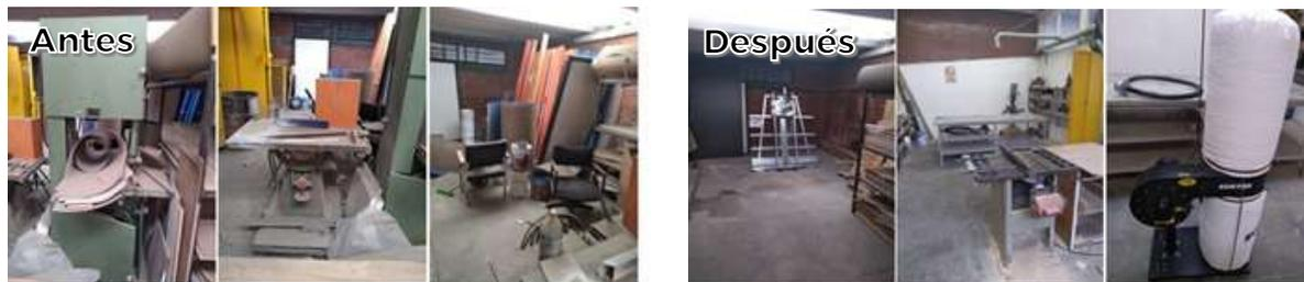
**Figura 31.** Fotografías que muestran el antes y después de la implementación 5's en el almacén de herramientas y equipo.
