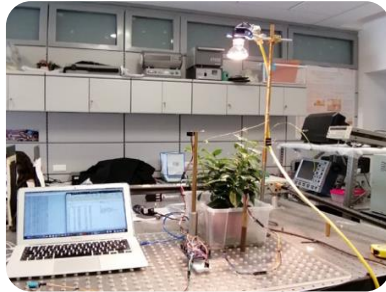
Sistema de recolección de datos para diferentes intervalos de iluminación
