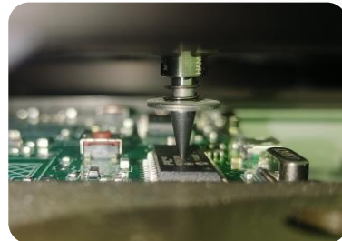
Proceso de ensamble automatizado, se muestra detalle del montaje del microcontrolador
