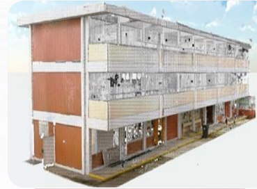
Nube de puntos del edificio C1 del plantel MDC
