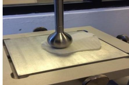
Prueba de desempeño mecánico hecha a un andamio meniscal obtenido usando el sistema acoplado electrospinning-impresora 3D.
