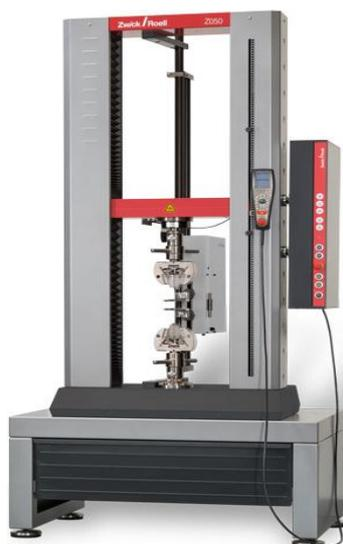
**Equipo de Pruebas Mecánicas, para ensayos físicos o mecánicos marca Zwick/Roell modelo Z050, capacidad de 50 KN (50,000 N ó 5 Toneladas)**
