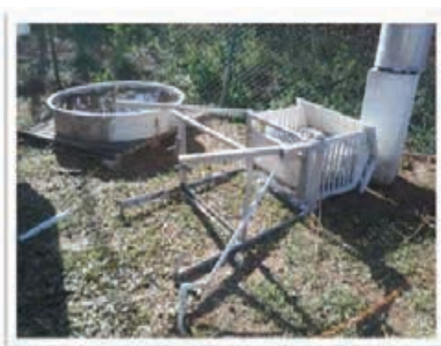
2. Estación meteorológica manual derribada
