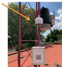
El PEMBU amplió sus capacidades de medición instalando, en cada uno de los planteles de las prepas y CCHs de la UNAM, un sensor de bajo costo para la medición de partículas finas (PM2.5) que ya está en operación
