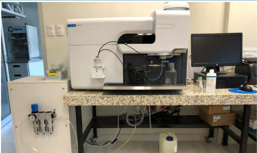
**Espectrómetro de emisión atómica de plasma por microondas de Nitrógeno.**
