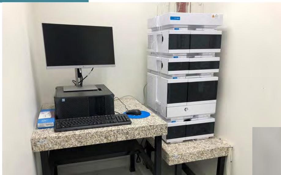
**Sistema de Cromatografía de Líquidos de Ultra-alta Presión UHPLC.**
