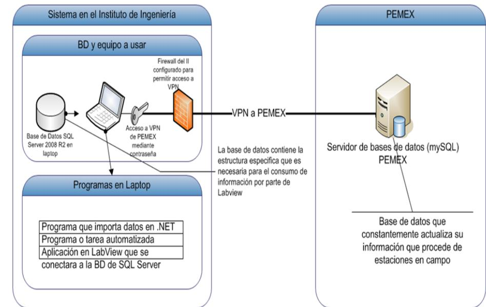
Comunicación del Sistema VIVI-UNAM de Detección de Fuga conectado a la Base de Datos de PEMEX.
