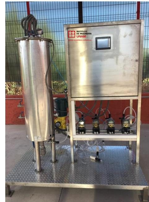
Reactor productor de hidrógeno
