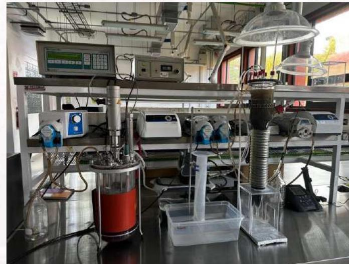
Reactor piloto de laboratorio (Izquierda, sistema acidogénico. Derecha UASB metanogénico).
