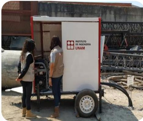
Primer equipo móvil en México (TRT-IIUNAM) para la ejecución de **Ensayos de Respuesta Térmica**
