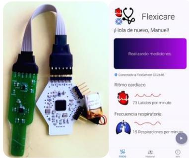
Dispositivo bioelectrónico para monitoreo y registro de variables fisiológicas con la aplicación móvil "Flexicare"
