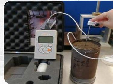
Medición en laboratorio de **propiedades térmicas** del suelo de Puerto Vallarta con el **Método de la Aguja Térmica**
