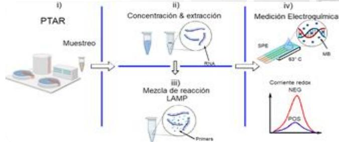
Diagrama de bloques de un sensor electroquímico para detección de SARS-CoV-2 en aguas residuales para fines de vigilancia epidemiológica
