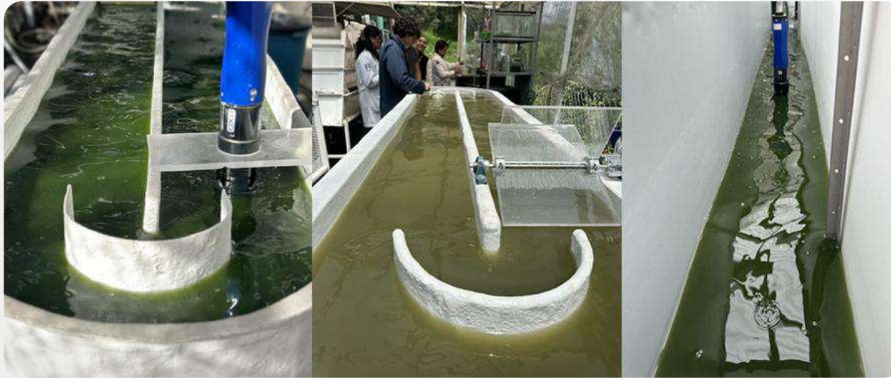
Sistema Atztintli - Reactores de alta tasa (300L, 600L y 1.2 m 3 ) Instalados en CU
