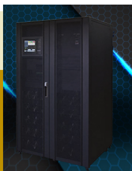
Figura 15. UPS modelo PA MPP3-04S60 Power-All, con capacidad de 60kVA/54kWatts.
