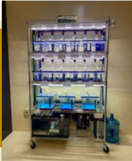
Figura 26. Sistema de peceras de flujo continuo de agua tratada.
